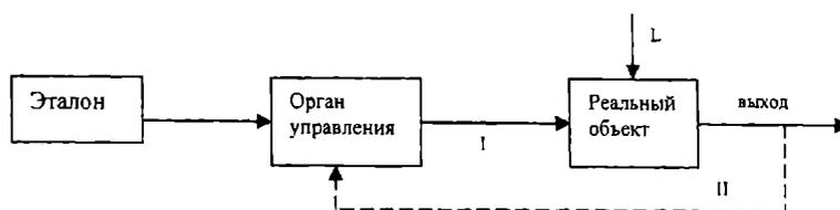
Рис. 1.1. Блок-схема системы с обратной связью:
